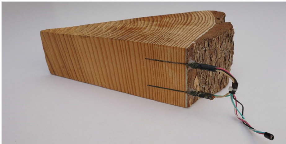
Illustration 8 : capteurs de flux de sève. Source : Fernando Casares, Université de Cordoue
