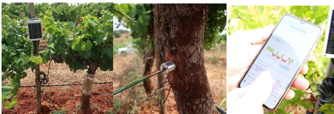
Illustration 10 : système de contrôle continu du potentiel hydrique du tronc composé de micro tensiomètres installés sur le tronc des vignes
