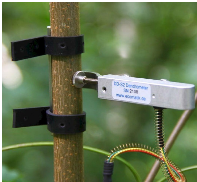
Illustration 7 : dendromètre. Source : Fernando Casares, Université de Cordoue
