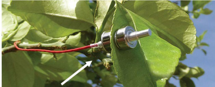
Illustration 9 : capteur de turgescence foliaire. Source : Francisco Casasres, Université de Cordoue
