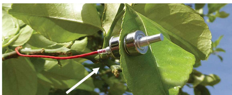
Figura 9: Sensor de turgescência da folha. Fonte: Francisco Casasres Universidade de Córdoba
