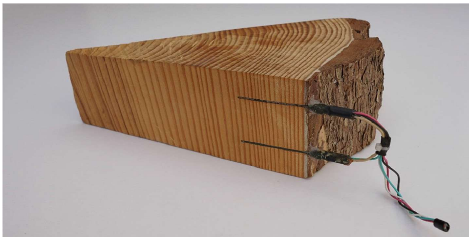
Figura 8: Sensores de fluxo de seiva. Fonte: Fernando Casares Universidade de Córdoba
