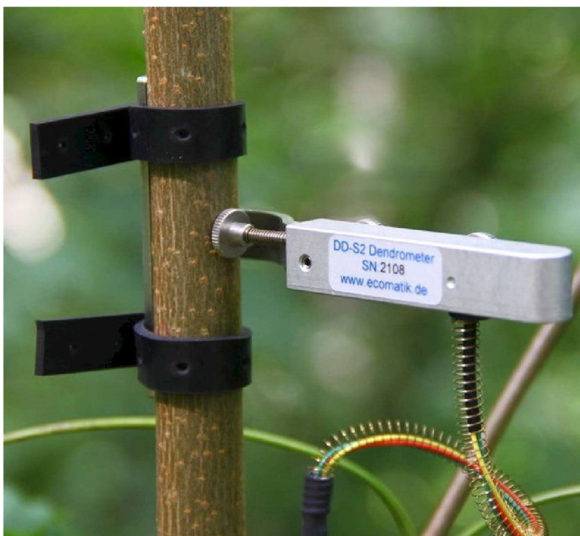
Figura 7: Dendrômetro. Fonte Fernando Casares Universidade de Córdoba
