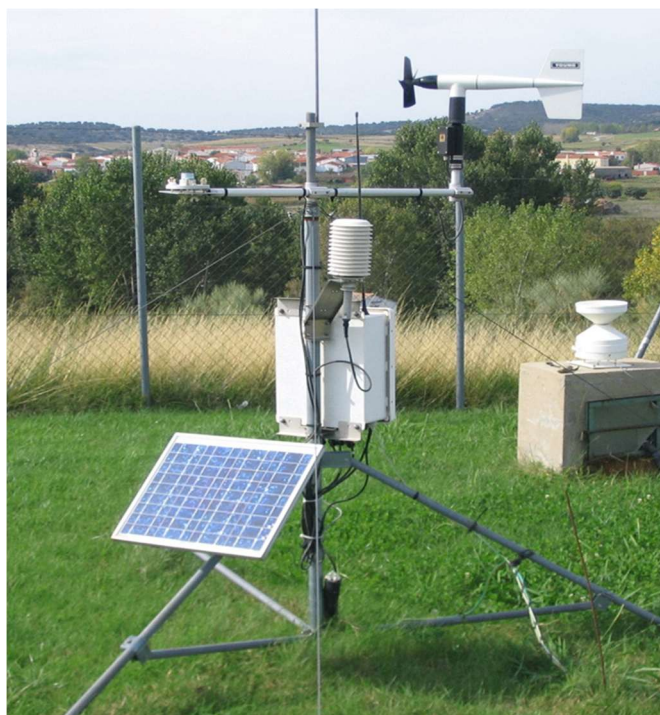
Figura 20: Estação agroclimática completa
