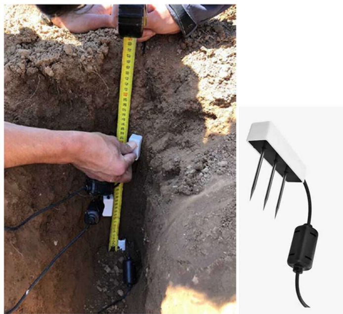
Figura 16: Instalação de sondas de humidade a várias profundidades
