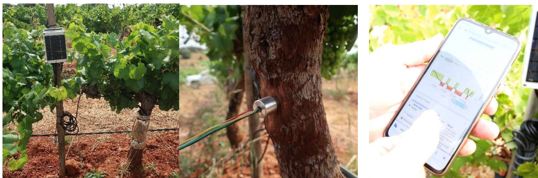
Figura 10: Equipamento para monitorização contínua do potencial hídrico do tronco com base em microtensiómetros instalados no tronco das videiras.
