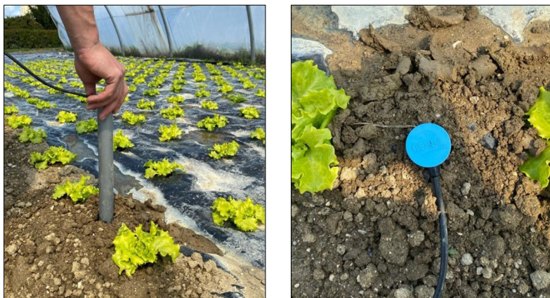
Figure 4 : Image d'une sonde tubulaire et de son installation.
