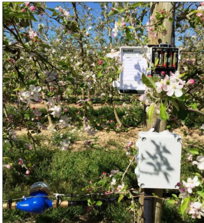
Figure 6 : Vue de face d'un datalogger Em500 alimenté par piles, avec un compteur d'eau à impulsions, dans un verger de pommiers.
