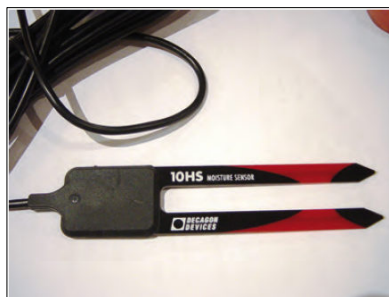
Figure 2 : Capteur FDR, 10HS ECHO Decagon
