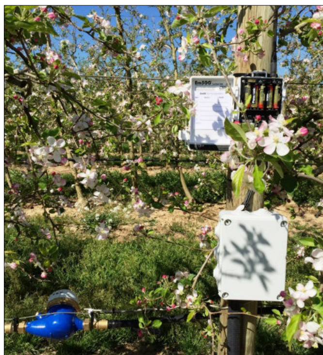
Figura 6: Vista frontal de um datalogger Em500 alimentado por pilhas com um contador de água de impulsos num pomar de macieiras.
