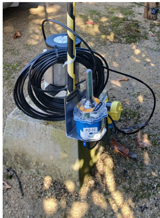
Figures 6 : Types de capteurs pour contrôler le niveau d'eau d'un bassin : (à gauche) sonde de pression hydrostatique, (au centre) sonde radar, (à droite) sonde à ultrasons. Figure 7 : Capteur de pression hydrostatique, enregistreur de données (datalogger) et système de transmission de données à installer dans le piézomètre.
