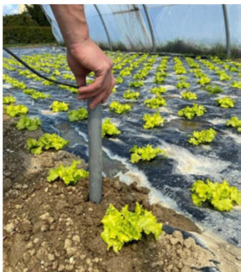
Figure 9 : Mise en place dans le sol de capteurs d'humidité intégrés dans un même instrument, en culture maraîchère.
