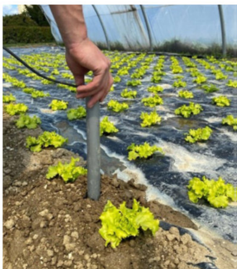
Figura 9: Colocação no solo de sensores de humidade integrados num mesmo instrumento, numa cultura hortícola.
