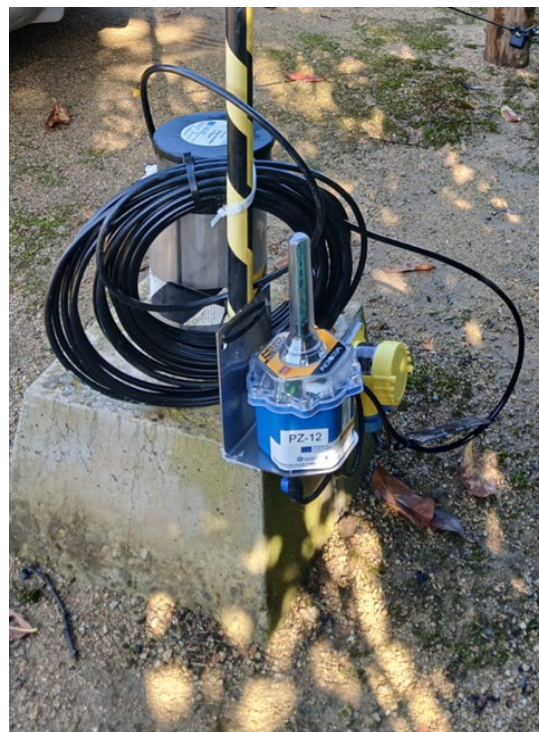
Figuras 6: Tipos de sensores para controlar o nível de água de um reservatório: (esquerda) Sonda de pressão hidrostática, (centro) Sonda radar, (direita) Sonda ultrassônica. Figura 7: Sensor de pressão hidrostática, datalogger e sistema de transmissão de dados para instalar dentro do piezômetro.
