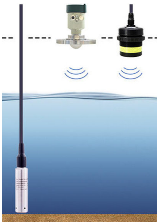
Figuras 6: Tipos de sensores para controlar o nível de água de um reservatório: (esquerda) Sonda de pressão hidrostática, (centro) Sonda radar, (direita) Sonda ultrassônica. Figura 7: Sensor de pressão hidrostática, datalogger e sistema de transmissão de dados para instalar dentro do piezômetro.
