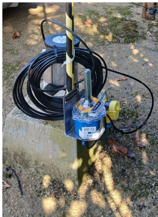
Figuras 6: Tipologías de sensores para controlar nivel de agua de una balsa: (izquierda) Sonda de presión hidrostática, (centro) Sonda radar, (derecha) Sonda ultrasónica. Figura 7: Sensor de presión hidrostática, datalogger y sistema de transmisión de datos para instalar dentro del piezómetro.
