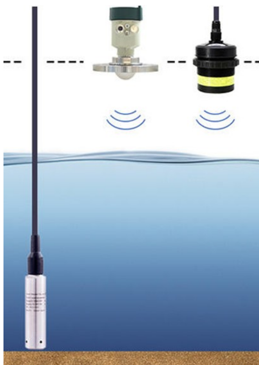
Figuras 6: Tipologías de sensores para controlar nivel de agua de una balsa: (izquierda) Sonda de presión hidrostática, (centro) Sonda radar, (derecha) Sonda ultrasónica. Figura 7: Sensor de presión hidrostática, datalogger y sistema de transmisión de datos para instalar dentro del piezómetro.
