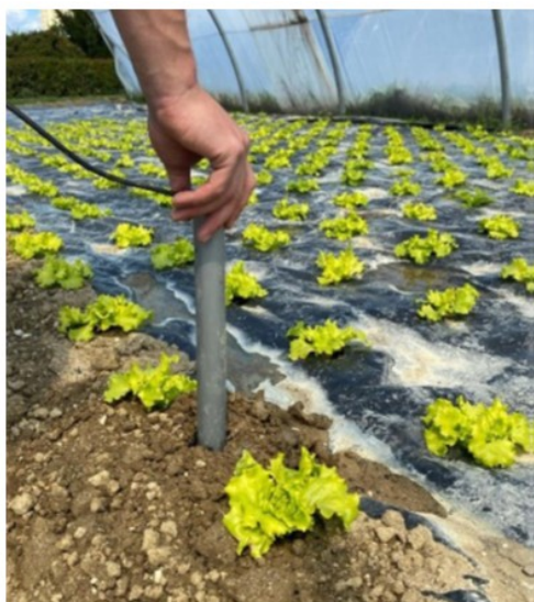
Figura 9: Colocación de sensores de humedad integrados en un mismo instrumento en el suelo en cultivo hortícola.
